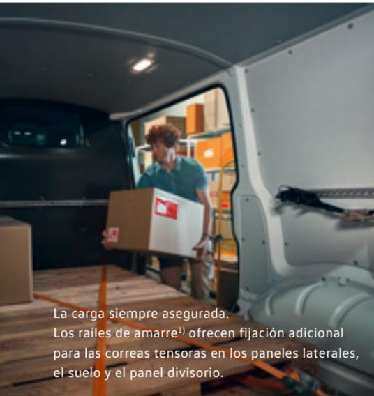
La carga siempre asegurada. Los raíles de amarre<sup>1)</sup> ofrecen fijación adicional para las correas tensoras en los paneles laterales, el suelo y el panel divisorio.
