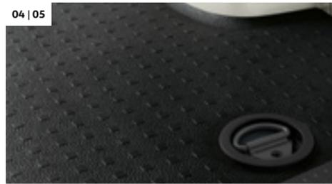
**04 Suelo de goma lavable y antideslizante.** Aumenta la seguridad mediante una superficie antideslizante que se extiende por el borde de carga y la iluminación del escalón. | F | MP | KO |
