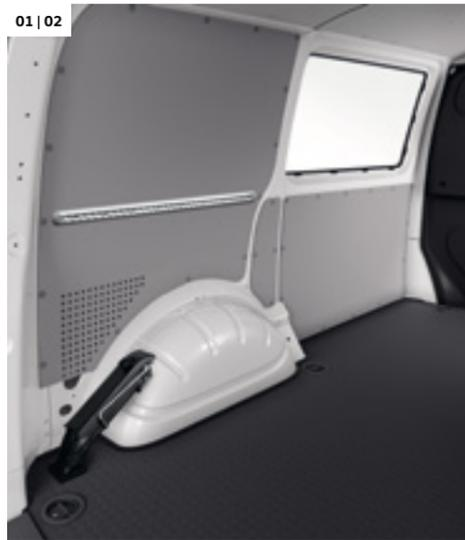
**01 Revestimiento lateral alto (tableros aglomerados).**<sup>1)</sup> Protección de los paneles laterales desde el suelo hasta la estructura del techo. | F | MP | KO |
