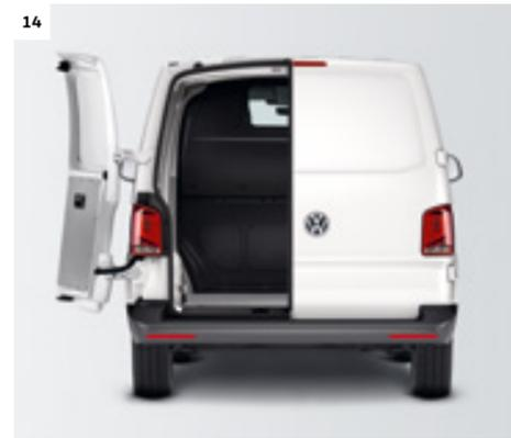
**12 Portón trasero sin ventana.** Permite una carga y descarga cómodas con una altura de apertura máxima de 2.200 mm.<sup>8)</sup> | F | MP |
