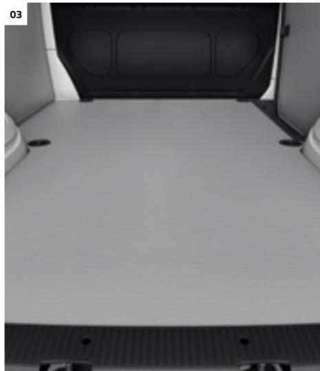
**03 Suelo universal (para montajes).** La preparación ideal para la instalación posterior de sistemas de armarios de distintos fabricantes.<sup>3)</sup> Los adaptadores especiales<sup>4)</sup> en los huecos situados en el revestimiento del suelo permiten una instalación flexible de los sistemas de armarios en cualquier momento sin necesidad de encolar ni taladrar. La retirada posterior del suelo apenas deja huella. | F |
