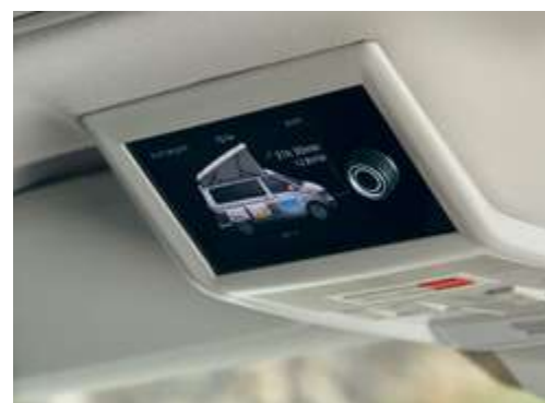
Control del suministro de energía y agua
