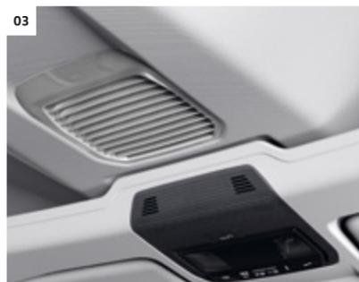
**03 Ventilación confort en la cabina de pasajeros.** El ventilador integrado en el techo aspira, mediante el cuadro de instrumentos, aire caliente o frío y lo distribuye por cinco salidas de aire por toda la cabina de pasajeros hasta la tercera fila de asientos.
